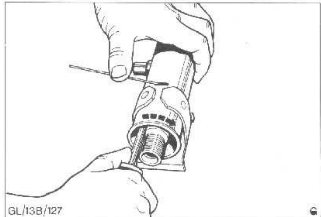
Abb.35 Lagerring im Uhrzeigersinn drehen, Draht in die Nut ziehend
