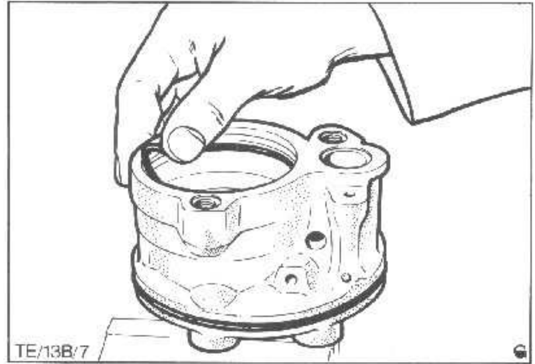
Abb.62 Einsetzen des O-Ringes für die Abschlußplatte
